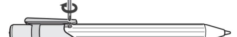
7. クリップを回転させて元の位置に戻します。
